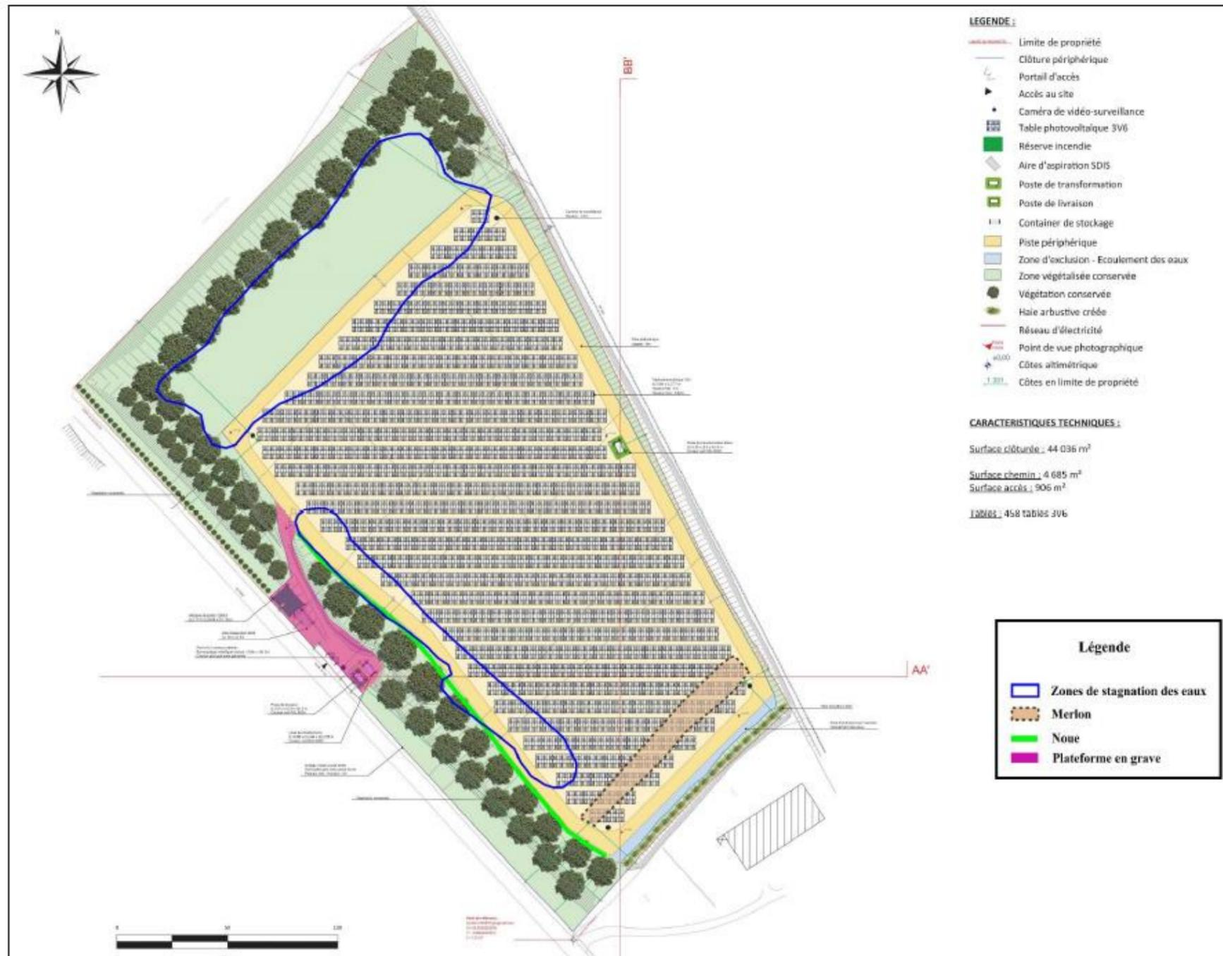
Figure 40 : Schéma de principe général pour la gestion des eaux pluviales
